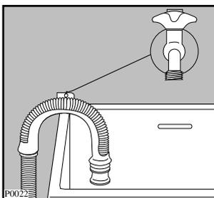
**Suoraan tyhjennysputkeen:** on hyvä käyttää 65 cm korkeaa putkea. Putki ei missään tapauksessa saa olla lyhyempi kuin 60 cm eikä pitempi kuin 90 cm.
