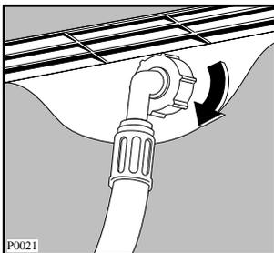
Vattenanslutningen kopplas till kallvatten. För vattenanslutning får endast den tillopps slang som medföljer maskinen användas. Använd inte en gammal, begagnad slang.
