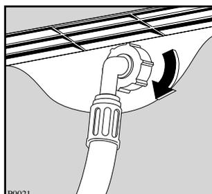
Ни в коем случае не используйте уже бывшие в употреблении наливные шланги. Другой конец наливного шланга, подключающийся к машине, может быть повернут в любом направлении. Ослабьте гайку, поверните шланг и вновь затяните гайку, проверив отсутствие течей воды. Наливной
