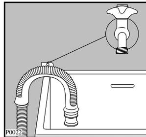
**Anslutning till golvbrunn:** Fäst ett rör på väggen, 60-80 cm från golvet och anslut avloppsslangen till röret. Avloppsslangens ändstycke skall vara ventilerat, d.v.s. rörets invändiga diameter skall vara min. 40 mm. Se till att slangen sitter fast och inte kan lossna.
