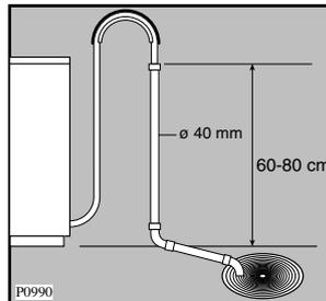
**Anslutning till vattenlås:** Då avloppsslangen ansluts till ett vattenlås under en tvätt- eller diskho, måste du kapa pipen på vattenlåset för att få största möjliga öppning så att maskinen kan tömmas ordentligt.
